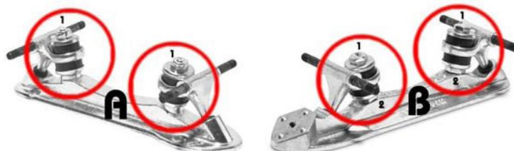
Tuhost treků lze také regulovat výměnou silentbloků za tvrdší/měkký. Při výměně dbejte na správný rozměr silentbloků a doporučení výrobce.
