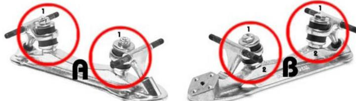
La rigidité des trucks peut aussi être réglée en remplaçant par des gommes plus souples / plus dures. Assurez-vous que les gommes sont de la taille correcte et respectez les recommandations du fabricant avant
